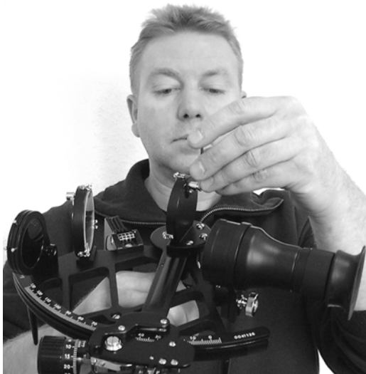
Sextant wie gezeigt fassen, um den Kippfehler des Indexspiegels zu erkennen und zu beseitigen
